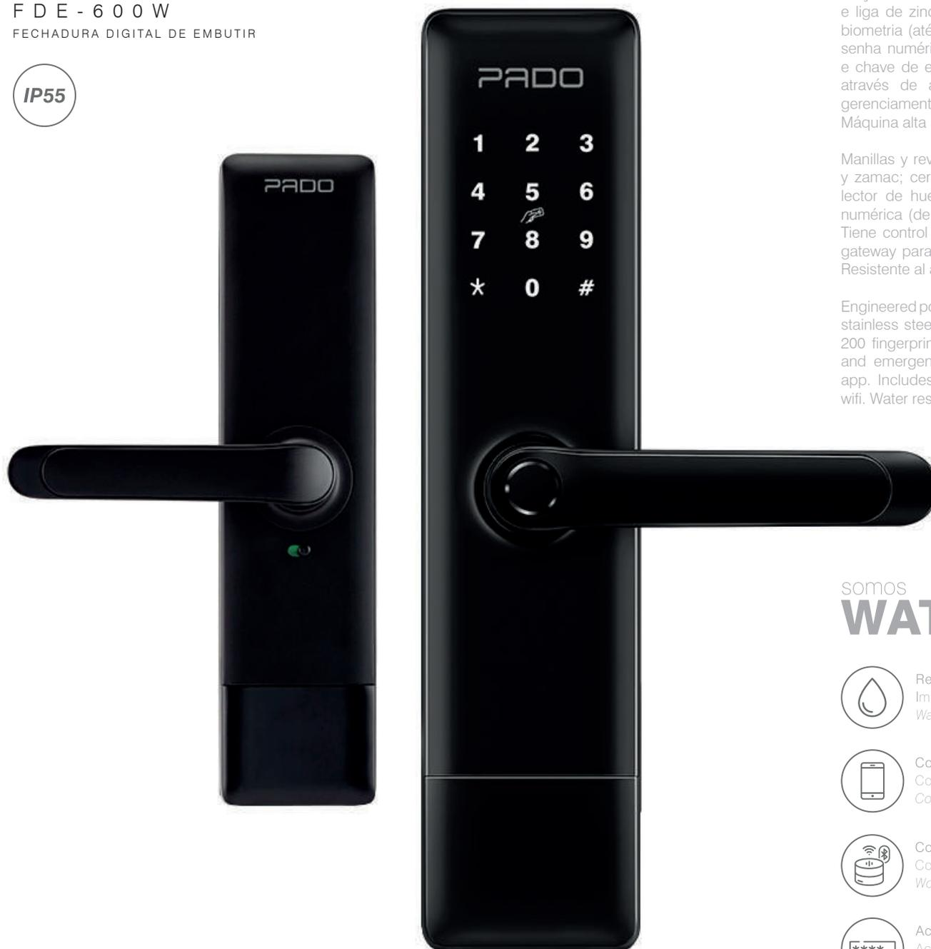
Maçanetas e guarnições em polímero de engenharia e liga de zinco; máquina em aço e aço Inoxidável; biometria (até 200 digitais), cartão (até 200 cartões), senha numérica (até 150 senhas de 3 à 15 dígitos) e chave de emergência. Possui controle de acesso através de aplicativo. Acompanha gateway para gerenciamento de acesso via WiFi. Resistente à água. Máquina alta segurança.
