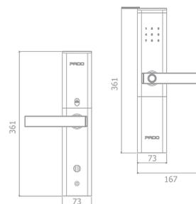
Maçanetas e guarnições em aço e polímero de engenharia; máquina em aço inoxidável; biometria (até 100 digitais), cartão (até 50 cartões), senha numérica (até 50 senhas de 3 à 15 dígitos) e chave de emergência. Possui controle de acesso através de aplicativo. Acompanha gateway para gerenciamento de acesso via wifi.
