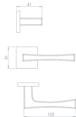
Maçaneta e roseta em zamac; testa e contra testa em aço inoxidável; cilindro em latão maciço. Manija en zamac; roseta, placa frontal y contra placa en acero inoxidable; cilindro en latón. Zinc alloy handle; stainless steel rosette, faceplate and strike plate; brass alloy cylinder.
