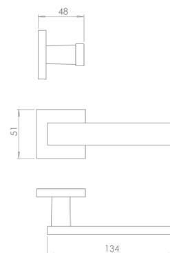
Maçaneta e roseta em zamac; testa e contra testa em aço inoxidável; cilindro em latão maciço. Manija em zamac; roseta, placa frontal y contra placa en acero inoxidable; cilindro en latón. Zinc alloy handle; stainless steel rosette, faceplate and strike plate; brass alloy cylinder.
