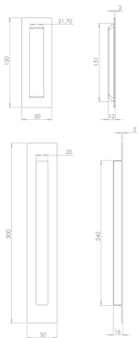
Puxador em aço inoxidável. Aplicação em madeira. Manillón en acero inoxidable. Aplicación en madera. Stainless steel door puller. Application in wood.
