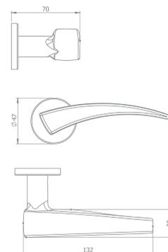
Maçaneta em zamac; Roseta, testa e contra testa em aço inoxidável; cilindro em latão maciço. Manija em zamac; roseta, placa frontal y contra placa en acero inoxidable; cilindro en latón. Zinc alloy handle; stainless steel rosette, faceplate and strike plate; brass alloy cylinder.
