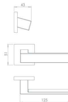
Maçaneta e roseta em zamac; testa e contra testa em aço inoxidável; cilindro em latão maciço. Manija en zamac; roseta, placa frontal y contra placa en acero inoxidable; cilindro en latón. Zinc alloy handle; stainless steel rosette, faceplate and strike plate; brass alloy cylinder.
