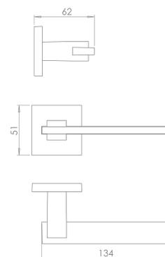
Maçaneta e roseta em zamac; testa e contra testa em aço inoxidável; cilindro em latão maciço. Manija em zamac; roseta, placa frontal y contra placa en acero inoxidable; cilindro en latón. Zinc alloy handle; stainless steel rosette, faceplate and strike plate; brass alloy cylinder.
