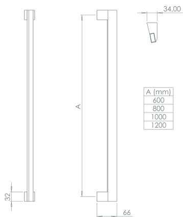
Puxador em aço inoxidável. Aplicação em vidro ou madeira. Manillón en acero inoxidable. Aplicación en vidrio o madera. Stainless steel door puller. Application in glass or wood.
