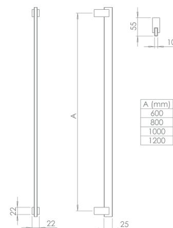
Puxador em aço inoxidável. Aplicação em vidro ou madeira. Manillón en acero inoxidable. Aplicación en vidrio o madera. Stainless steel door puller. Application in glass or wood.
