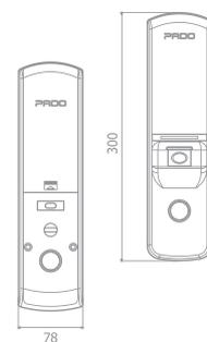
Guarnições em polímero de engenharia; máquina em Zamac, aço inox e carbono; biometria (até 196 digitais), senha numérica (de 3 a 15 dígitos) e chave de emergência.
