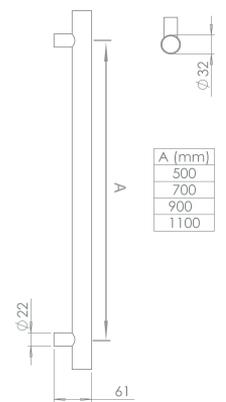
Puxador em aço inoxidável. Aplicação em vidro ou madeira. Manillón en acero inoxidable. Aplicación en vidrio o madera. Stainless steel door puller. Application in glass or wood.
