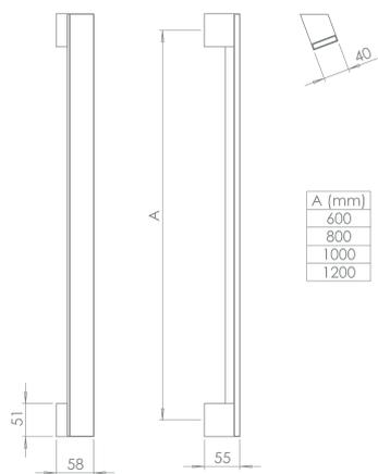
Puxador em aço inoxidável. Aplicação em vidro ou madeira. Manillón en acero inoxidable. Aplicación en vidrio o madera. Stainless steel door puller. Application in glass or wood.
