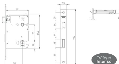
**70PE** Máquina 70mm - Cilindro Tradicional Porta Externa
