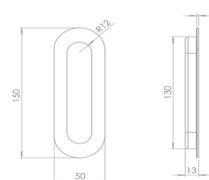
Puxador em aço inoxidável. Aplicação em madeira. Manillón en acero inoxidable. Aplicación en madera. Stainless steel door puller. Application in wood.
