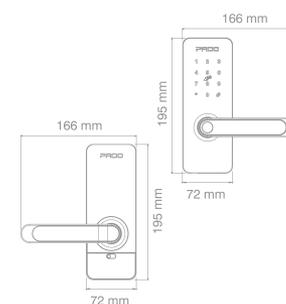
Maçanetas e guarnições em polímero de engenharia e liga de zinco; máquina em aço e aço inoxidável; biometria (até 200 digitais), cartão (até 200 cartões), senha numérica (até 150 senhas de 3 à 15 dígitos) e chave de emergência. Possui controle de acesso através de aplicativo. Acompanha gateway para gerenciamento de acesso via WiFi. Resistente à água.
