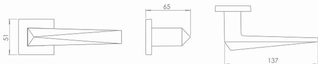
Maçaneta e roseta em zamac; testa e contra testa em aço inoxidável; cilindro em latão maciço. Manija em zamac; roseta, placa frontal y contra placa en acero inoxidable; cilindro en latón. Zinc alloy handle; stainless steel rosette, faceplate and strike plate; brass alloy cylinder.
