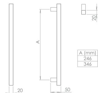
Puxador em aço inoxidável. Aplicação em vidro ou madeira. Manillón en acero inoxidable. Aplicación en vidrio o madera. Stainless steel door puller. Application in glass or wood.
